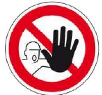
Nicht fertiggestellte Gerüste oder Gerüstbereiche müssen mit dem Verbotsschild "Zutritt für Unbefugte verboten" gekennzeichnet werden. Bitte grenzen Sie den Zugang zum Gefahrenbereich angemessen ab.
